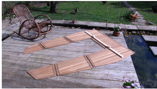
Auslegen des Cockpitbelags.
